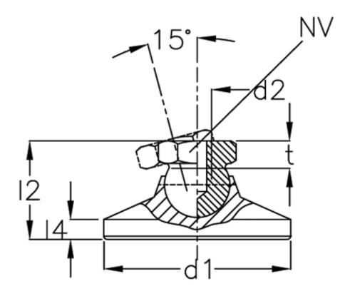
d1 = 25 d2 = 6 l2 = 19 l4 = 4 NV = 12 Static load (kN) = 7.5 t min = 9
